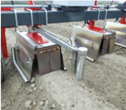
Windkap met infrarood straling
