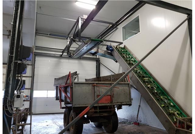
continu. La courroie en PVC transporte les déchets verts jusqu'à l'endroit souhaité. Un système de déchargement automatique pour le remplissage des chariots est optionnel. La courroie en PVC est toujours intégrée au sol.
