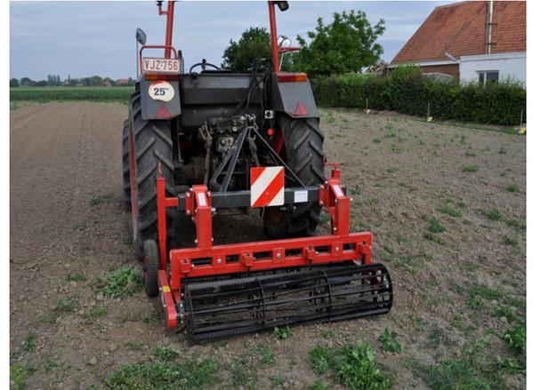
Avec un système parallèle séparé par rouleau, et avec une lame ou un outil pour niveler les croûtes entre les 2 rouleaux.
