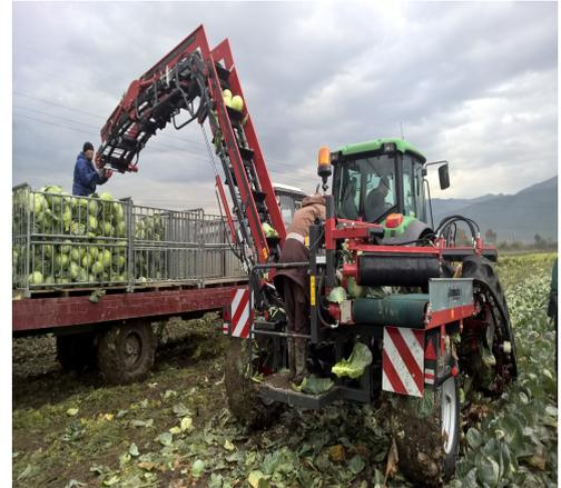
courroies de serrage en ligne droite et à la bonne hauteur. Ainsi, la lame réglable électriquement en hauteur peut couper parfaitement jusqu'à 99 % de la racine des choux.
